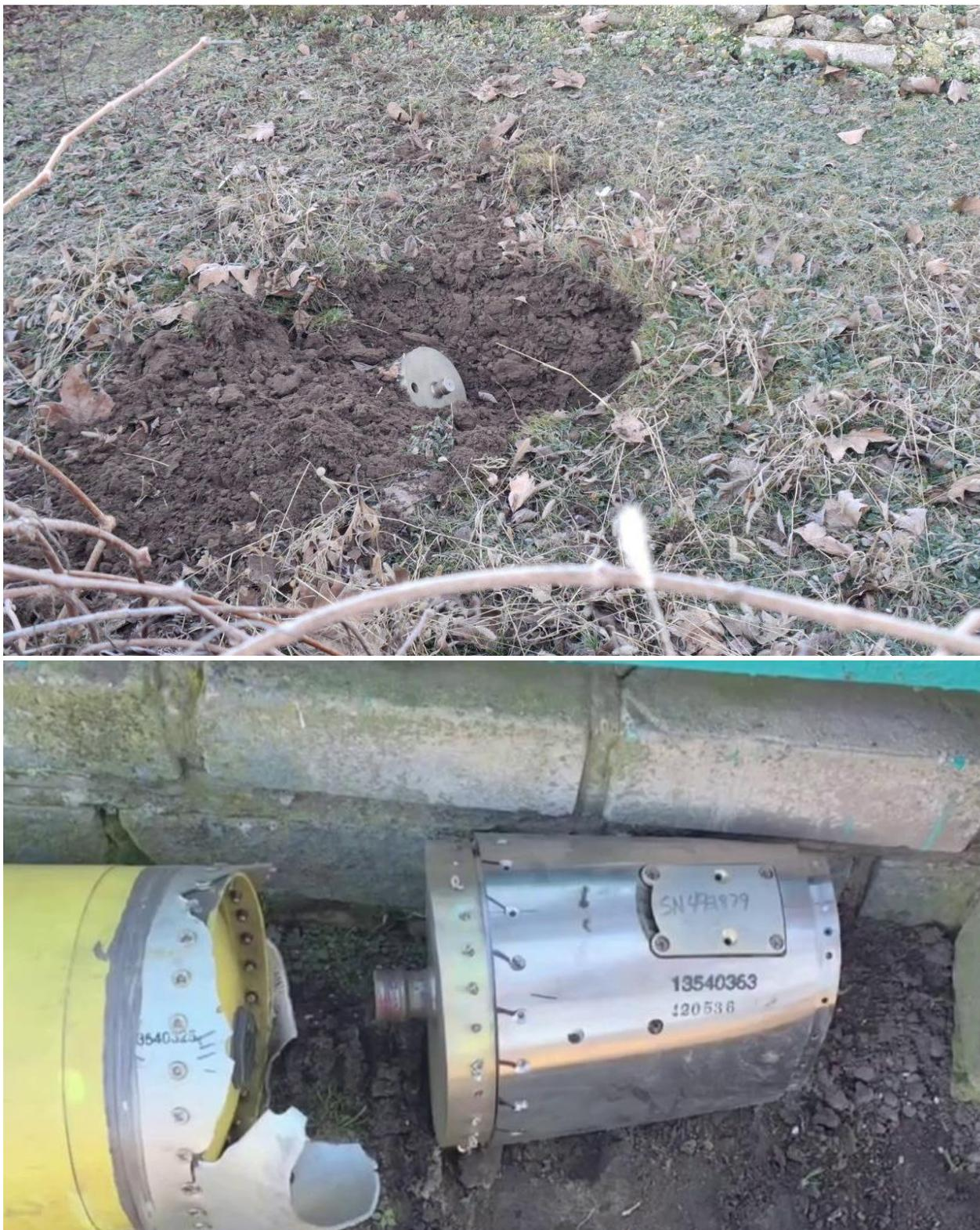
**Рис. 14 - Блок наведения и управления реактивного снаряда:**
