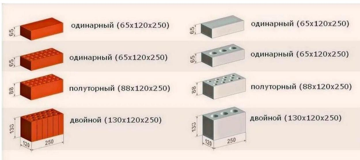
Рис. 16 - Стандартные размеры кирпича согласно ГОСТ 530-2012.
