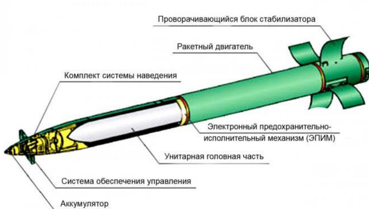
Рис. 13 - Схема устройства снаряда M31A1 GMLRS.
