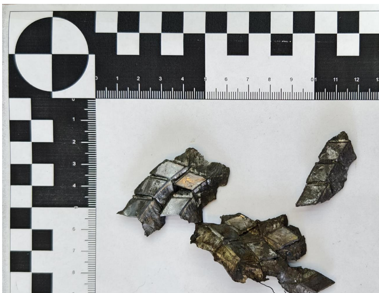
Рис. 8 - Фрагменты осколочной рубашки реактивного снаряда, найденные на местах попаданий №4 и №6.
