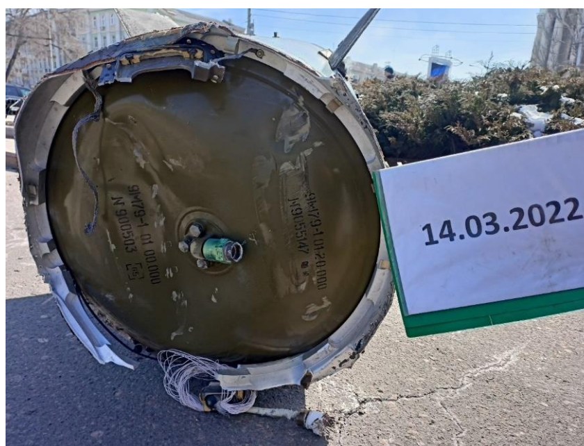
Рис. 16 – Маркировка на торце двигательной установки ракеты «Точка-У», упавшей на пересечении бул. Шевченко и ул. Артёма 48 .
