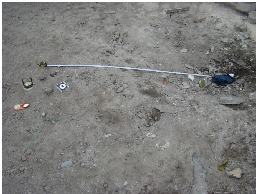
Рис. 14 – Определение направления траектории артиллерийского снаряда.
