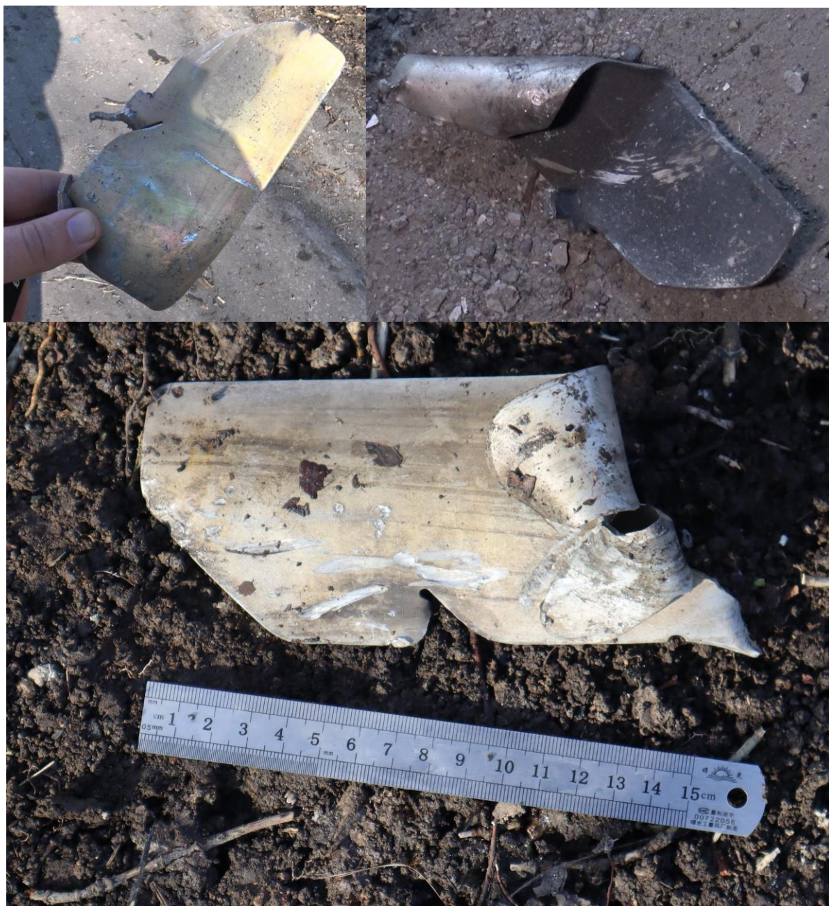
Рис. 17 - Остатки лопастей стабилизаторов реактивного снаряда РСЗО обнаруженные: сверху слева - попадание 5, сверху справа - попадание 6, внизу - попадание 8.
