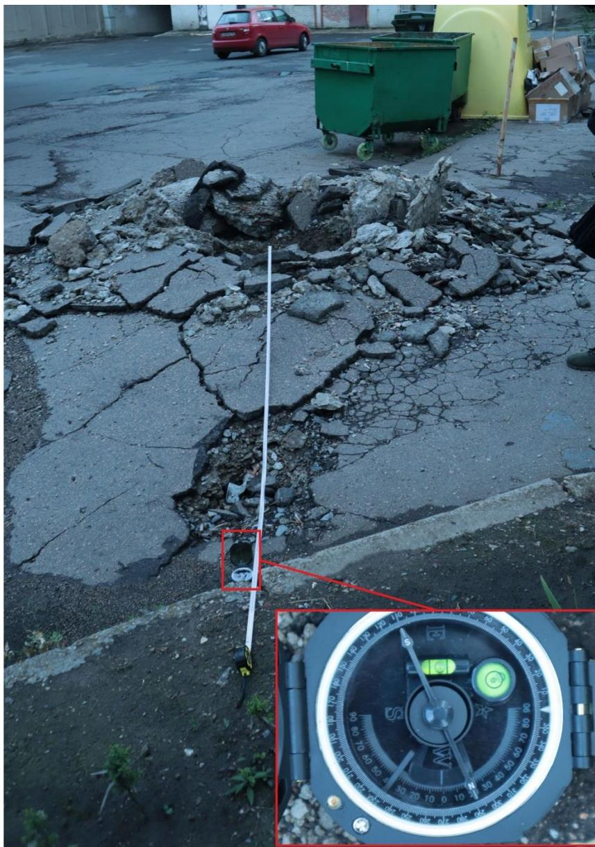
*Рис. 45 – Определение азимута на месте попадания № 20.*
