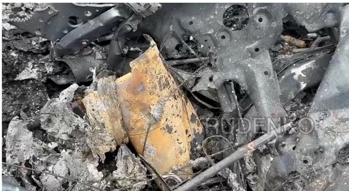
*Рис. 10 – Обнаруженный в автомобиле деформированный обгоревший фрагмент ракетного двигателя снаряда<sup>17</sup>.*
