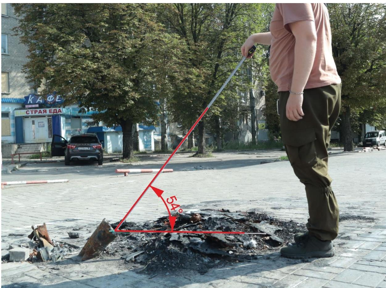
*Рис. 44 – Определение угла встречи снаряда с горизонтальной поверхностью на месте попадания № 8.*
