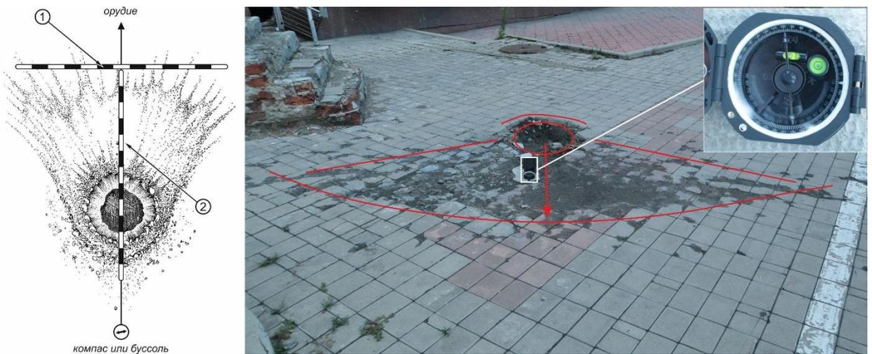
*Рис. 42 – Определение направления обстрела методом осколочных канавок.*
