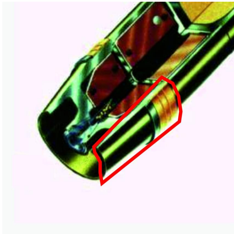
Рис. 5 – Донная часть активно-реактивного снаряда М549/М549А1 (красным выделена часть как правило обнаруживаемая в виде крупных осколков на месте взрыва).
