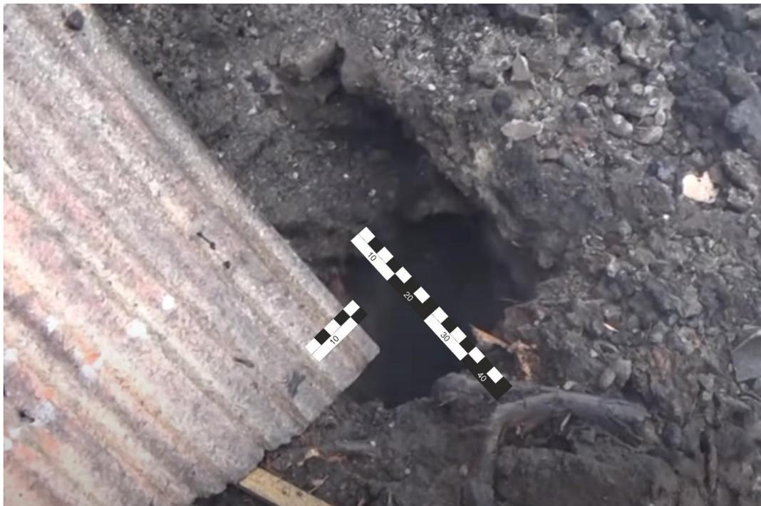
Рис. 41 – Определение размера отверстия, оставленного РЧ РСЗО (попадание № 7).
