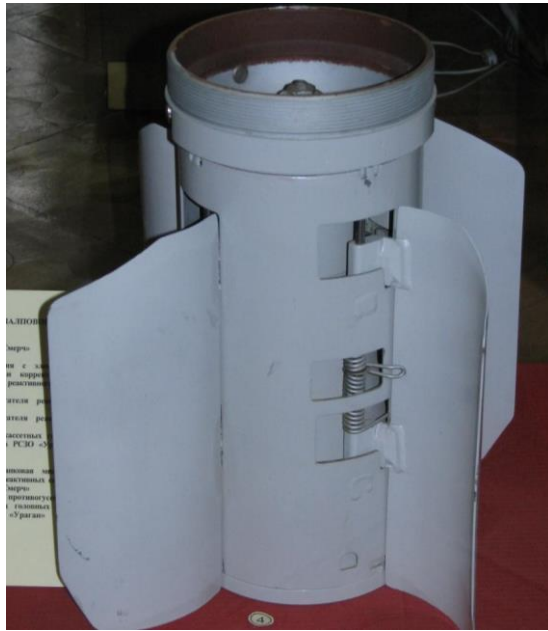
Рис. 30 – Макет блока стабилизатора снаряда РСЗО «Ураган» 48 .
