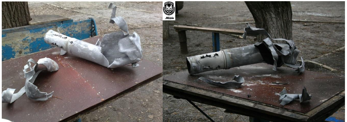
Рис. 26 - Остатки ракетной части снаряда РСЗО 9К51 «Град», обнаруженные в районе попадания №9 44 .
