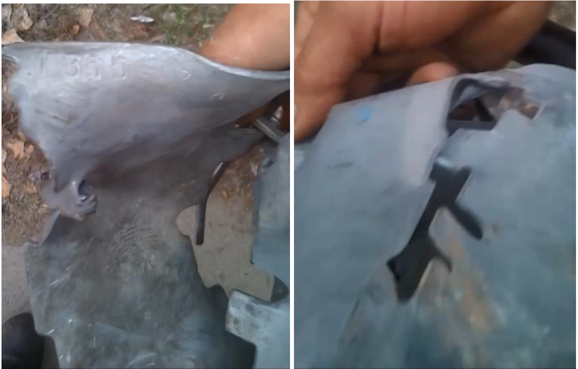
Рис. 27 - Остатки ракетной части снаряда РСЗО 9К51 «Град», обнаруженные в районе обстрела 07.02.2015 в городе Кировск. На левом рисунке видно отверстие характерной формы, справа видно отверстие характерной формы, оперение и выбитый номер «1355». 45
