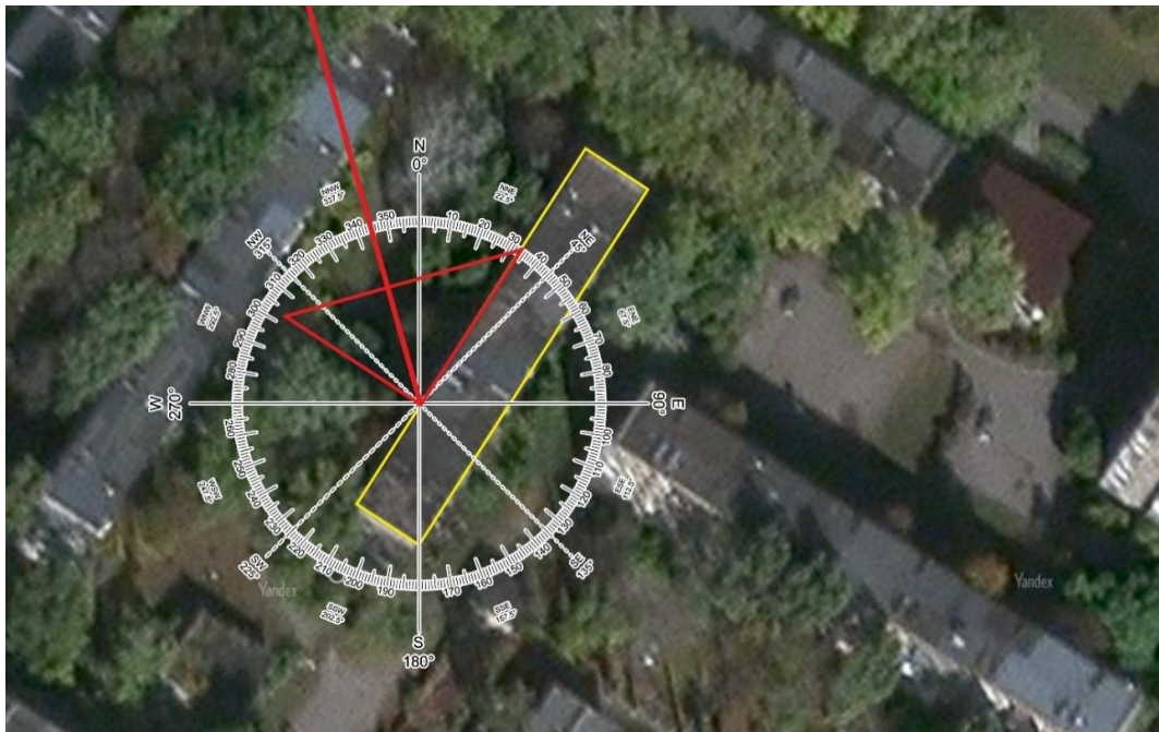
Рис. 22 – Определение направления, с которого осуществлялся обстрел по спутниковому снимку на основе геометрических построений (попадание № 5).
