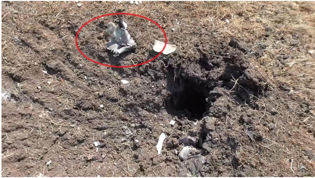
Рис. 12 – Фрагмент РЧ реактивного снаряда РСЗО (попадание № 1).
